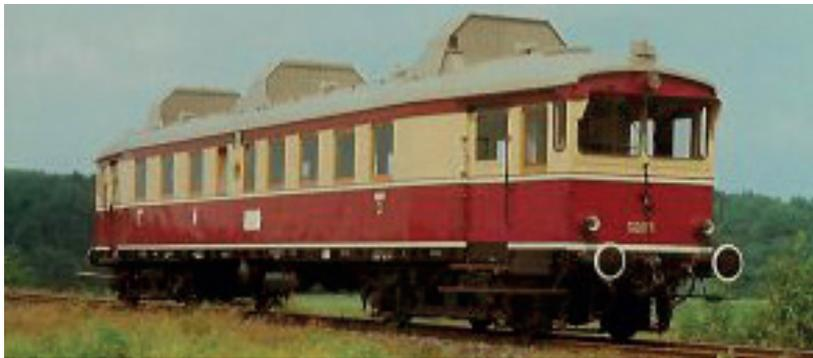
*Zwei solche benzolbetriebene Triebwagen vom Typ WUMAG VT 175 gehörten zum Bestand des Arsenal. Einer dieser Triebwagen war ausschließlich den Offiziere der Marineinspektion Bad Segeberg vorbehalten.*
